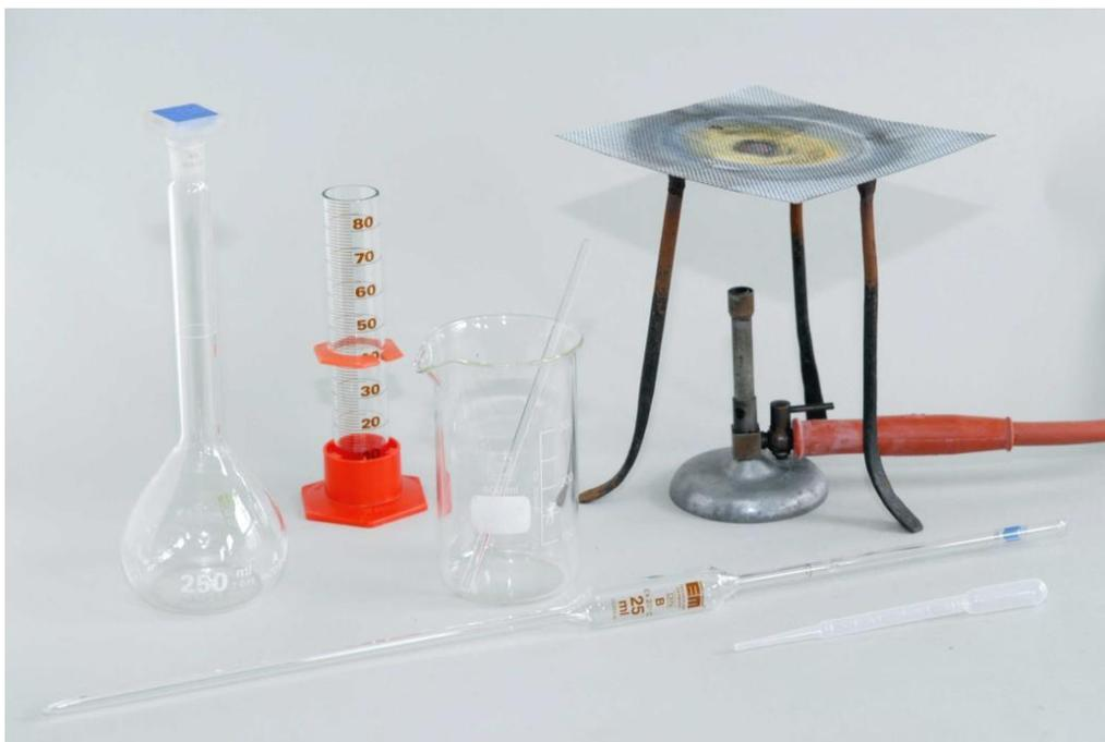
Abbildung 3: Inventar zur Durchführung der Nickel- Fällung
