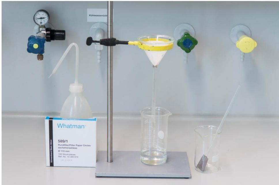
Abbildung 4: Experimentelle Anordnung für die Filtration des Eisen- Niederschlags
