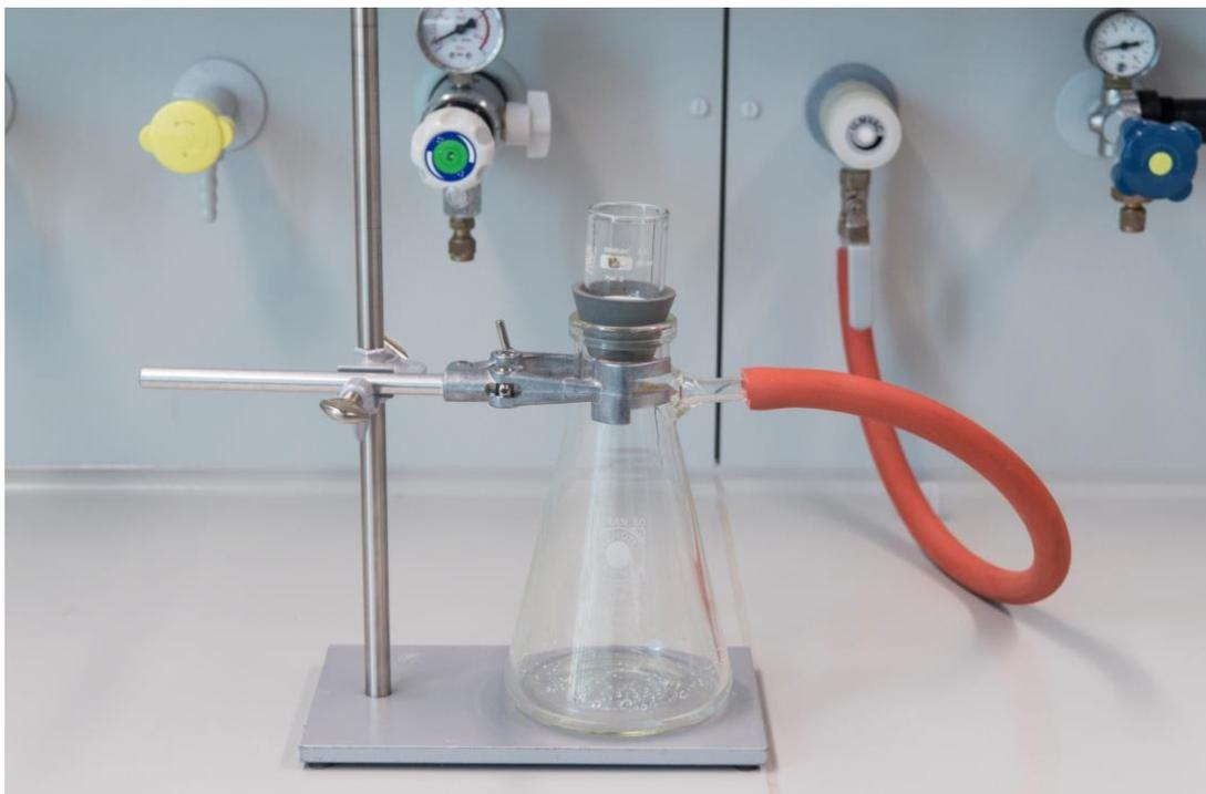
Abbildung 1: Apparativer Aufbau für eine Filtration unter vermindertem Druck
