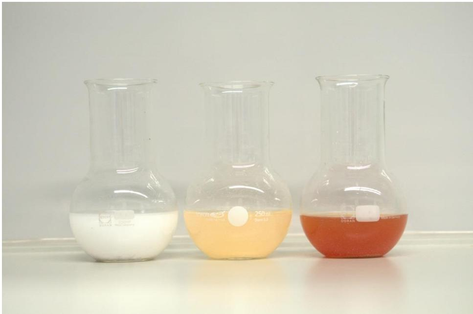
Abbildung 11: Farbumschlag bei der Titration eines Reagenzien-Blindwerts
