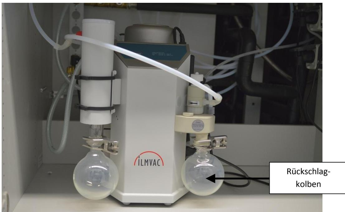
Abbildung 2: Position des Rückschlagkolbens
